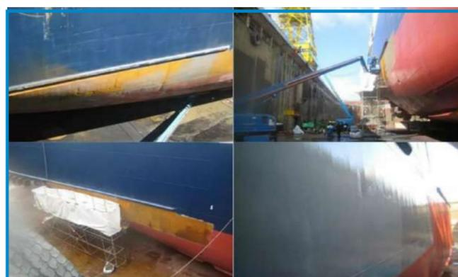
Se utilizó la pasta de reparación de metal UPS 105 EG para reconstruir el perfil de la superficie, y luego se dejó curar el material durante 6 horas. Enseguida, se aplicaron 2 capas de UPS 205 FG Fluid Grade Ceramic al área a reparar.
