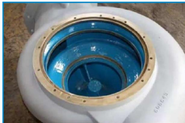
Se utilizaron para la aplicación UPS 200 EG seguida de dos capas de UPS 210 CR. La bomba fue limpiada con chorro abrasivo, revisada, reconstruida y recubierta en talleres en el Reino Unido y entregada nuevamente al astillero del cliente en Francia. UPS 210 CR es un recubrimiento epóxico cerámico, de alto brillo, diseñado para mejorar la eficiencia de flujo en equipos de capital crítico, resistir la abrasión del fluido y proteger contra la erosión y la corrosión.
